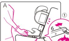
③ 表示が「赤色」から「緑色」に変わらない場合は、座面の前方を少し持ち上げる、または車両シートをリクライニング(倒す)するなどして、差し込み角度を調整し、もう一度[6:ISOFIXコネクタ]の差し込み操作をやり直してください。(この時はまだ、本製品は全部押し込まないでください。)
