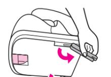
3 車両のISOFIX取り付け金具の位置を確認し、コネクタをISOFIX取り付け金具に「カチッ」と音がするまで差し込む。
