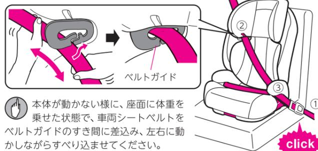
ⓘ 本体が動かない様に、座面に体重を乗せた状態で、車両シートベルトをベルトガイドのすき間に差込み、左右に動かしながらすり込ませてください。
