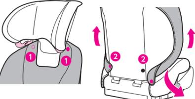
3 ①座面裏面4カ所のホックと②2カ所のゴムをはずし、座面カバーを取りはずす。
