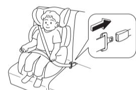
② 車両シートベルトをジュニアシートにかけて、バックルに確実にロックします。
