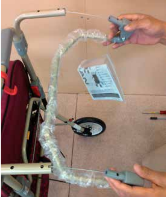
ワイヤーを引き抜いた状態
